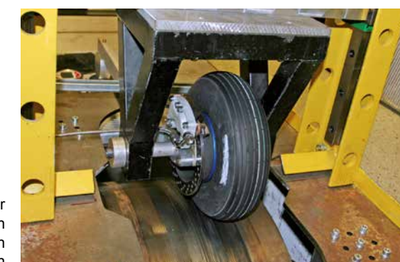
Systemtest zur realistischen Simulation von Landezyklen
