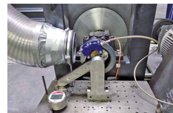
Bremstest mit Massenschwungrad zur Ermittlung der Bremsleistung
