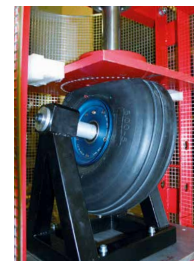
Statischer Belastungsversuch einer bereiften Felge
